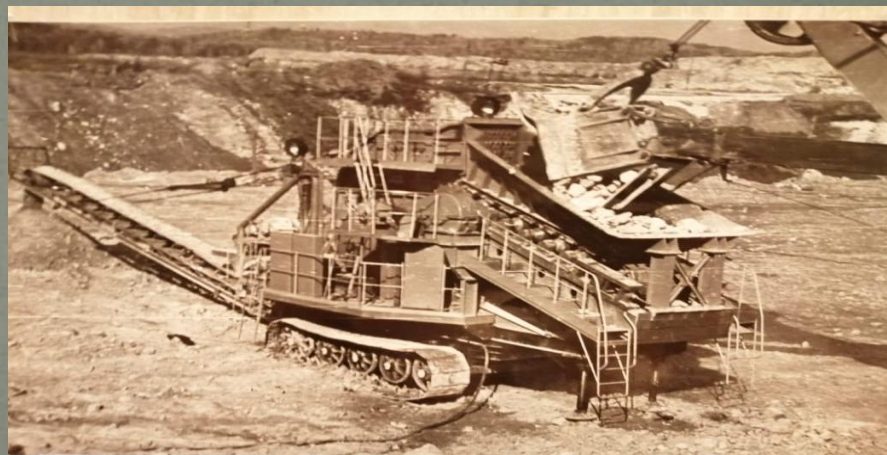
Самоходный дробильный агрегат СДА-1200 в период испытаний. 1980 г. МКУ «КГА» Ф. 1-К. Оп. 1-Ф. Д. 549.
