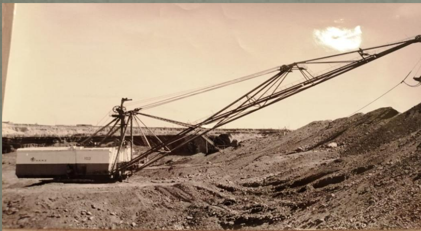
Экскаватор ЭЩ-10-75. 1975 г. (общий вид). МКУ «КГА» Ф. 1-К. Оп. 1-Ф. Д. 543.
